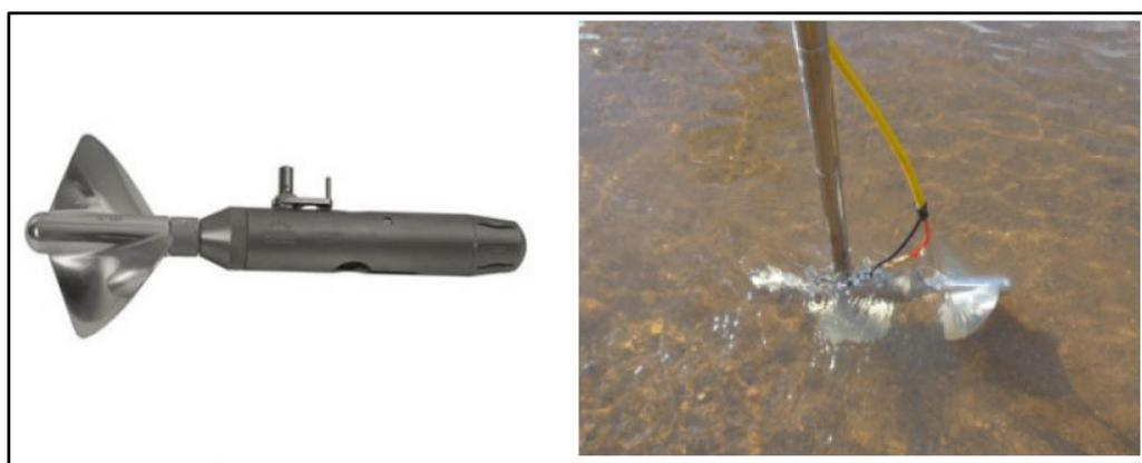
**Figura 3**. Molinete hidrométrico (Fonte: ENERGÊS, 2022)<sup>30</sup>.
