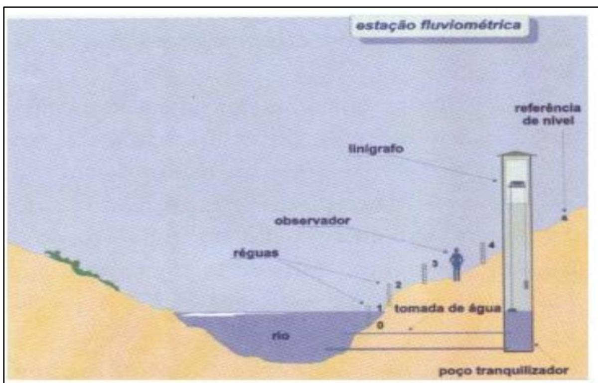
**Figura 15.** Estação Fluviométrica com réguas linimétricas e linígrafo (Fonte: CARVALHO, 2006)<sup>45</sup>
