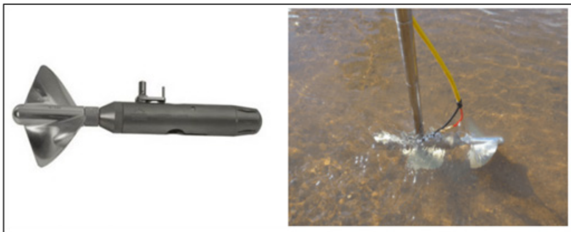
Figura 3. Molinete hidrométrico (Fonte: ENERGÊS, 2022) 29 .
